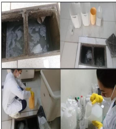
Figura 1 - Coleta de efluente para amostragem na Santa Casa de Fernandópolis.
